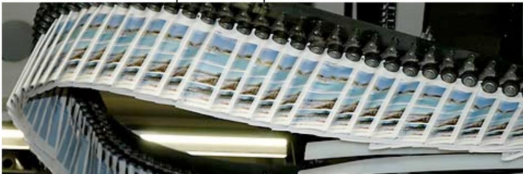
IDAB WAMAC – nastro trasportatore singolo
